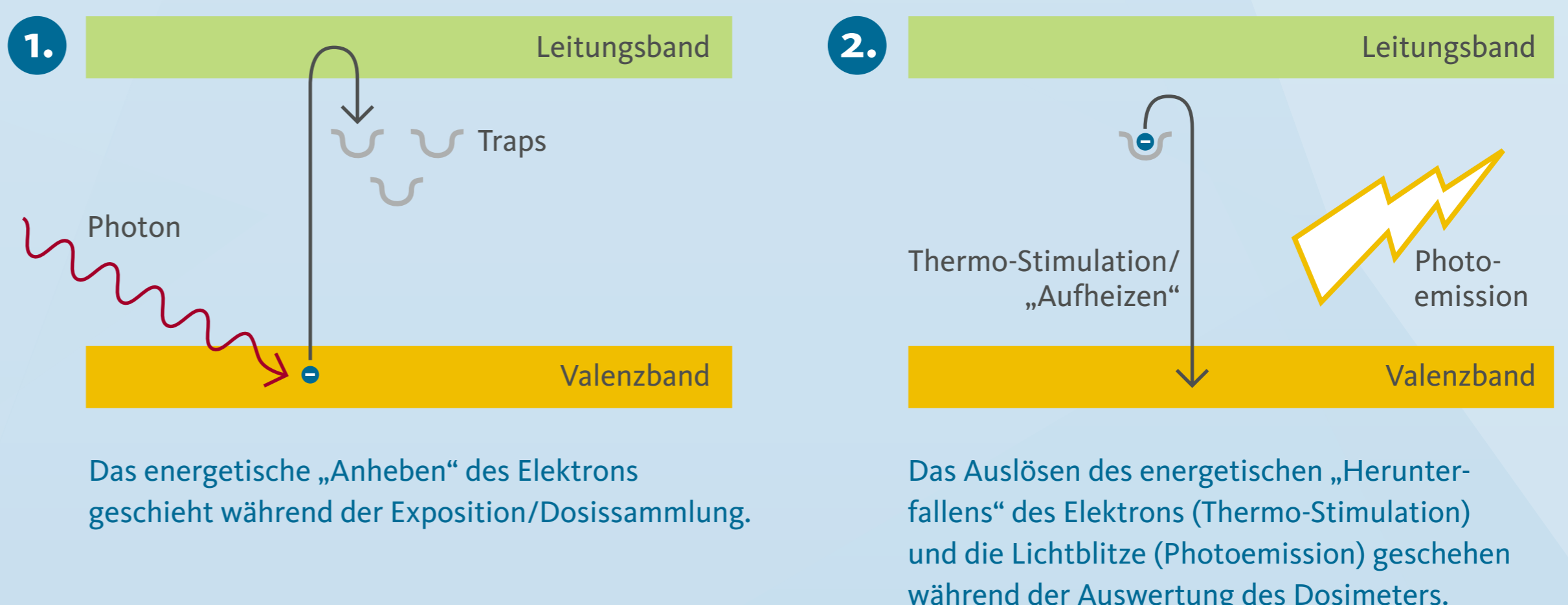
Messprinzip Thermolumineszenzdosimeter
