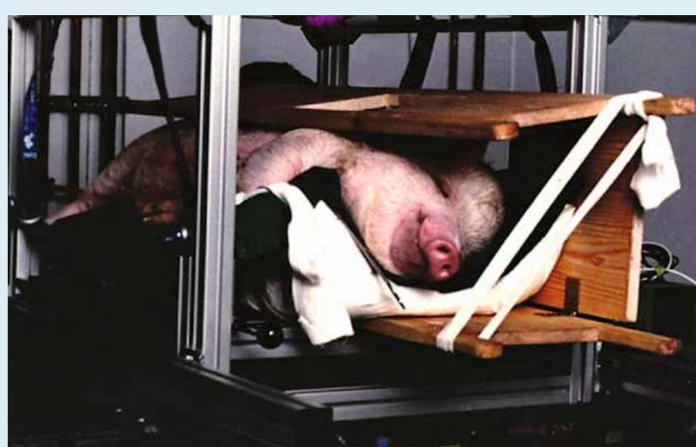
Test der Strahlenempfindlichkeit der Haut bei unterschiedlichen Dosen und Strahlqualitäten. Testobjekt ist ein Minischwein, dessen Haut der eines Menschen gleicht.
